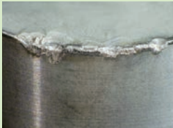
Competitor's whisker ceramics Tool life : 3min.
